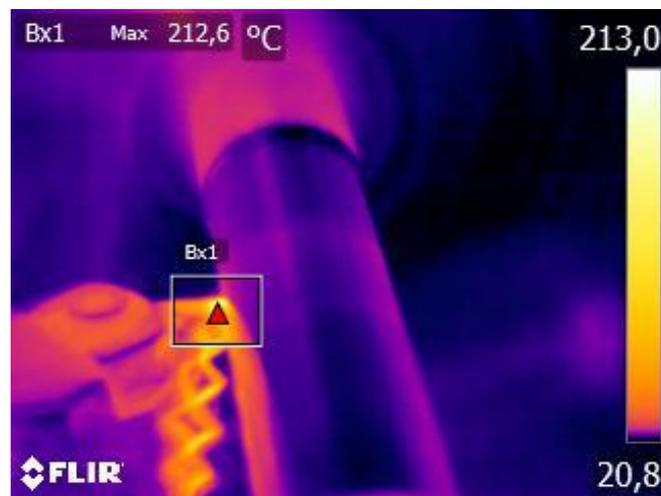
**Figura 7.** Corpo de prova 5;  $V_c=123,4$  m/min;  $f=0,201$  mm/rev;  $a_p=0,375$  mm
