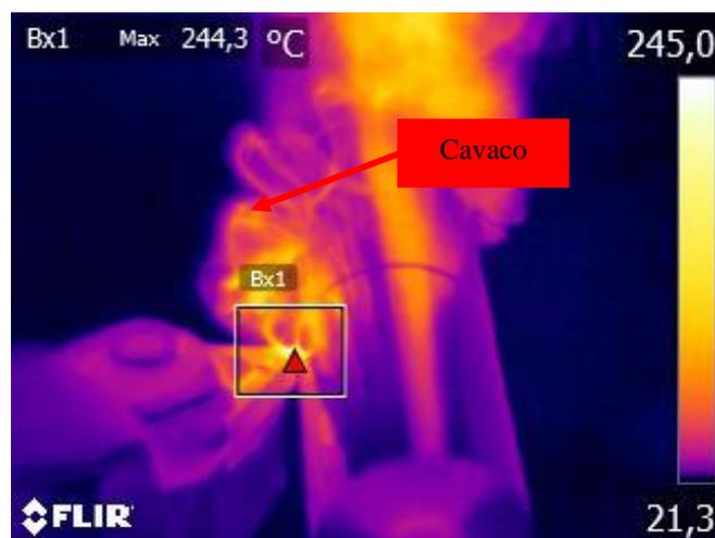
**Figura 5.** Corpo de prova 4;  $V_c=123,4$  m/min;  $f=0,100$  mm/rev;  $a_p=0,375$  mm
