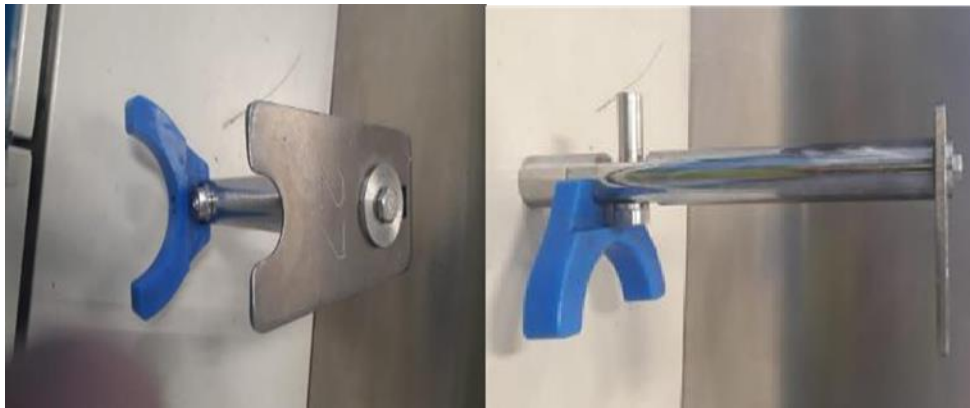
Figura 6. Peça piloto confeccionada para realização dos testes na máquina envasadora
