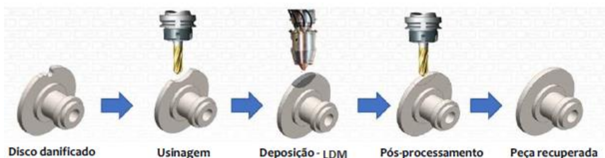
Figura 2 – Representação da recuperação de uma peça aplicando a manufatura híbrida
