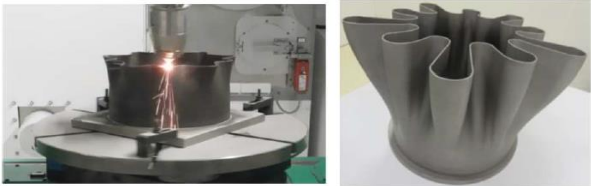
Figura 1 – Exemplo de aplicação LMD pelo processo de manufatura híbrida
