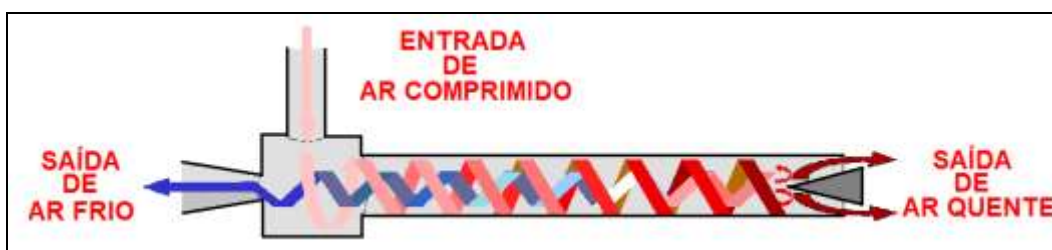
Figura 3 - Separação do fluxo de ar comprimido em fluxo quente e frio.
